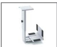
Support métallique en plaque pliée de 2 mm d'épaisseur. Réglable en hauteur et largeur pour s'adapter aux dimensions différentes. Fixation au plateau avec visse filetage bois. Il incorpore des protections en polyuréthane flexibles qui évitent des vibrations pour un ajustement optimal.
